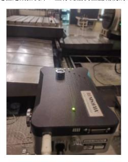
当高压连接在阳极和阴极之间时,混合气体被激发,形成激光光束,通过放大激光光强使一些光透射出来成为输出激光光束。其中,为实现平衡状态,通过加热器控制激光管长度让激光稳频的精度保持在±0.05ppm以内,此时稳定输出后,激光器即可进行干涉测量。如今大多数现代位移干涉仪都使用氦氖(HeNe)激光管,这些激光管具有633纳米的波长输出。从激光头射出的激光光束①具有单一频率,标称波长为633nm□长期波长稳定性(真空中)优于0.05ppm□当此光束到达偏振分光镜时,被分成两束光——反射光束②和透射光束③。这两束光被传送到各自的角锥反射镜中,然后反射回分光镜中,在嵌于激光头中的探测器中形成干涉光束④。安徽机床校准激光干涉仪激光干涉仪,以激光波长为已知长度,利用迈克耳逊干涉系统测量位移的通用长度测量。
