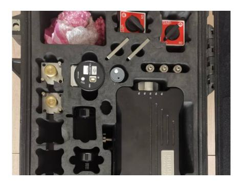
激光干涉仪使用注意事项: 1、仪器应放置在干燥、清洁以及无振动的环境中应用。2、在移动仪器时,为防止导轨变形,应托住底座再进行移动。3、仪器的光学零件在不用时,应在清洁干燥的器皿中进行存放,以防止发霉。4、尽量不要去擦拭仪器的反光镜、分光镜等,如必须擦拭则应当小心擦拭,利用科学的方法进行清洁。5、导轨、丝杆、螺母与轴孔部分等传动部件,应当保持良好的润滑。因此必要时要使用精密仪表油润滑。6、在使用时应避免强旋、硬扳等情况,合理恰当的调整部件。7、避免划伤或腐蚀导轨面丝杆,保持其不失油。
