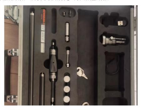
激光干涉仪以光波为载体,具有测量精度高、测量速度快、测量范围大、比较高测速下分辨率高等特点, 其光波波长可直接对米进行定义并溯源至国家标准。因此,激光干涉仪普遍应用于数控机床[]PCB钻孔机、坐标 测量机、位移传感器等精密仪器的质量控制与校准以及科研开发、设备制造等领域。激光干涉仪会在相长性和 相消性干涉的两极之间找到稳定的信号。若光程差有变化时,这些变化会被计算并用来测量两个光程之间的差异变化。激光干涉仪发射单一频率光束,光束射入线性干涉镜后分成两道光束射向反射镜,这两道光束再反射回到分光镜,比较后重新汇聚返回激光干涉仪。激光干涉仪的测量精度高。安徽机床校准激光干涉仪
